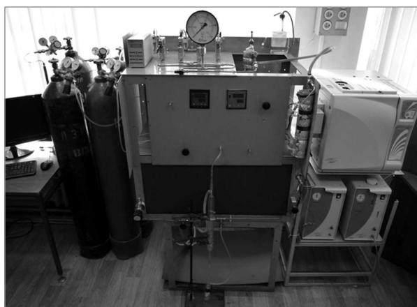
**Рис. 2** Общий вид проточной лабораторной установки для исследования окислительного крекинга алканов  $C_{2+}$
