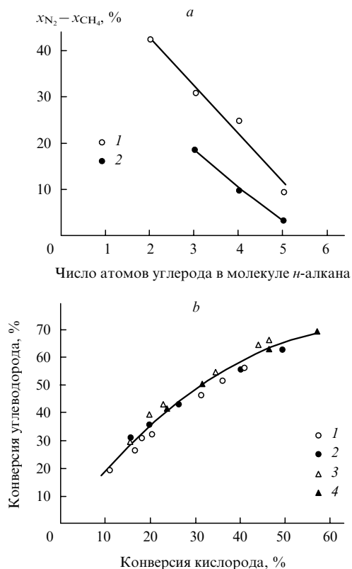
Рис. 36. Зависимости разности степеней превращения кислорода (1) и углеводородов (2) в среде азота и метана ( x_{N_2} - x_{CH_4} ) от числа атомов углерода в молекуле исходного n -алкана при t_r = 2 с (а) и конверсии углеводорода от конверсии кислорода при парциальном окислении пропана и n -бутана в среде азота и метана при t_r = 0.3 - 1.9 с (б). 50 [ C_nH_{2n+2} ] 0 = 5%, [ C_nH_{2n+2} ] 0 : [ O_2 ] 0 = 2 : 1, T = 700^\circ\text{C} ; а: 1 — O_2 , 2 — C_3H_8 ; б: 1 — C_3H_8 ( CH_4 ), 2 — C_3H_8 ( N_2 ), 3 — C_4H_{10} ( CH_4 ), 4 — C_4H_{10} ( N_2 ).
