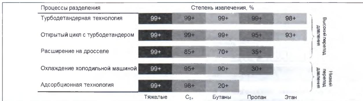
Рис. 3. Технологии удаления тяжелых углеводородов
