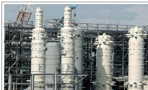
Рис. 7. Главные криогенные теплообменники фирмы Linde в схеме завода
