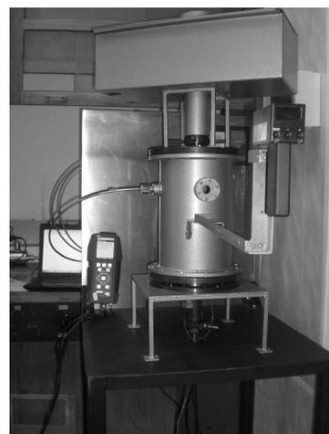
**Рис. 4.** Концептуальная схема многокамерной малоэмиссионной камеры сгорания ГТУ (а) и ее лабораторный макет (б);  $D_1$  и  $D_2$  — наружный диаметр колец из проницаемого для газа материала, образующих полости матрицы, и диаметр выходного канала соответственно;  $L_1$  и  $L_2$  — линейный размер единичного звена матрицы и расстояние между рабочими поверхностями в единичном звене матрицы соответственно.
