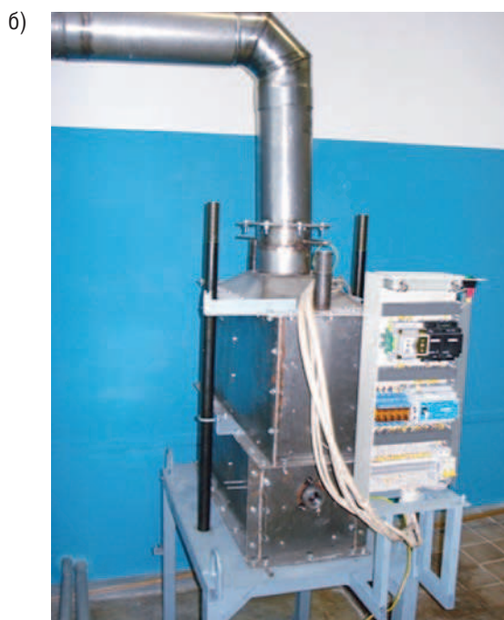
РИС. 6. Принципиальная схема работы конвертора на основе проницаемой объемной матрицы (а) и демонстрационный конвертор атмосферного давления производительностью до 20 м³/ч по входящему газу (б)
